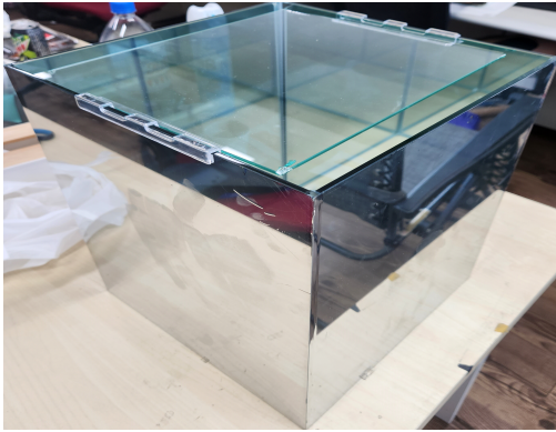
그림 10. 적외선, 가시광선 차단 필름 부착한 적외선 차단 유리 실험체 Fig. 10. Infrared Screening Glass Experiment with Infrared, Visible Light Screening Film
